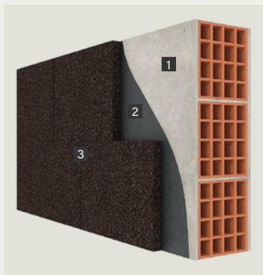
1. Suporte _ Base 2. Colagem _ Bonding 3. Aglomerado de cortiça expandida – Tipo REV_ Expanded Corkboard – Type REV
